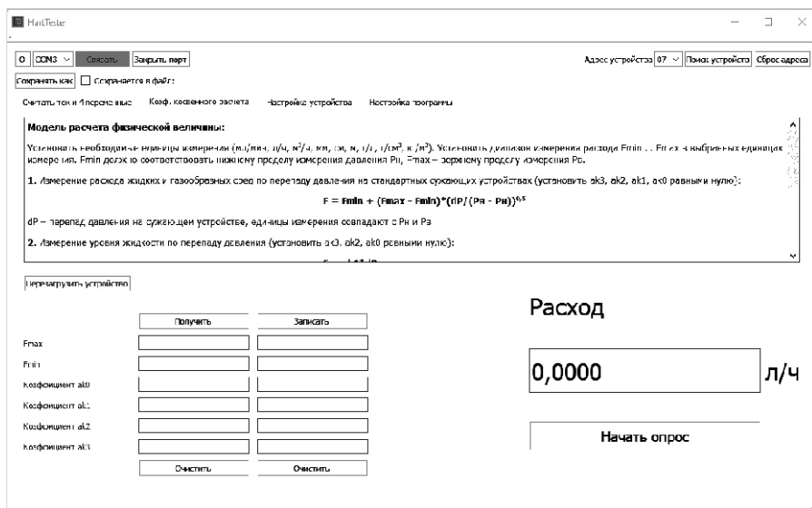
Рисунок 39 – Настройка расчета расхода, уровня и плотности среды в программном комплексе HartTester
